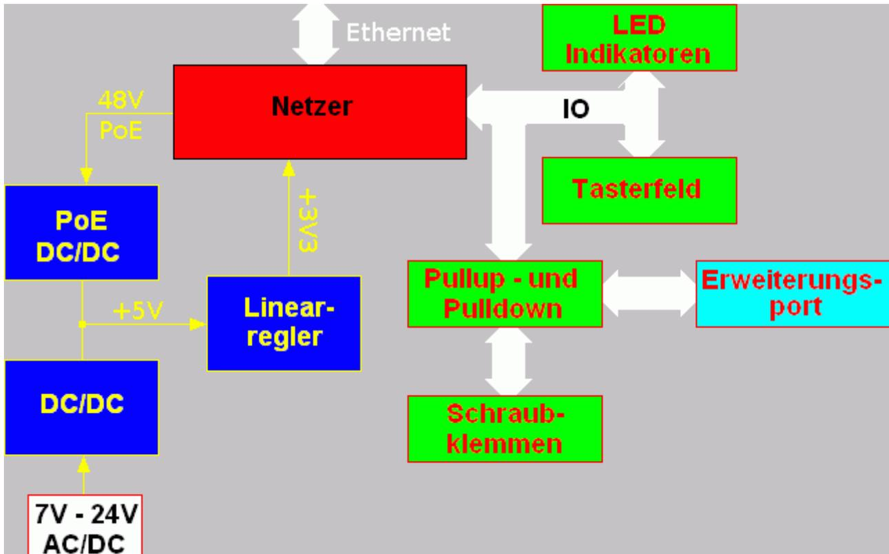
Eine besondere Rolle kommt dem **Erweiterungsport** zu. Je nach Anforderung können Erweiterungsplatinen gesteckt werden. Erweiterungsplatinen für die **LCD-Anbindung** sowie **Heimautomatisierung** (mit Relais, Optokopplereingängen, Temperatur- und Helligkeitssensor) sind in Entwicklung.
