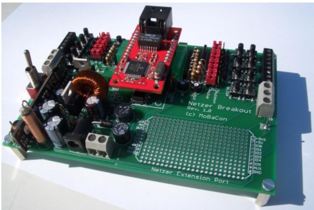
Mit dem [Netzer Spielfeld](#), einer Experimentierplatine für das Ethernet-Gateway Netzer, können sehr schnell eigene Schaltungen in Betrieb genommen werden. Der Netzer wird einfach aufgesteckt.
