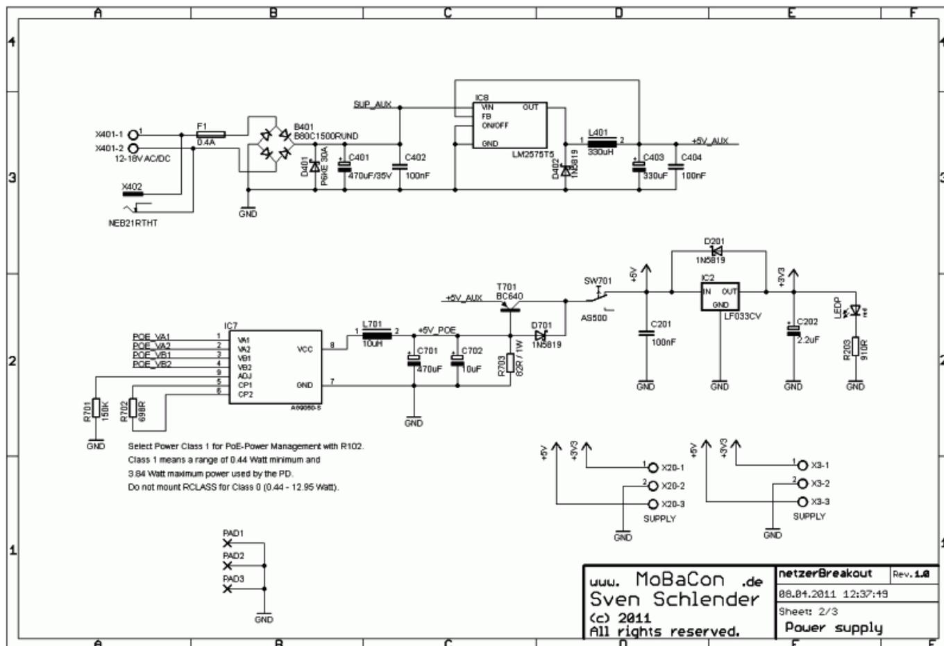
Sheet 2 zeigt die Stromversorgung. Die Eingangsspannung (6V - 24V, AC oder DC) ist verpolsicher (B401), störfest (D401) und kurzschlussfest (F401) aufgebaut. Die dadurch gewonnene Spannung SUP\_AUX wird auf den Extension Port geführt. Der Schaltregler IC4 erzeugt in Kombination mit D401, L401 und den Sieb-Elkos (C402 und C403) aus SUP\_AUX eine stabile 5V (+5V\_AUX). Es wurde ein Schaltregler gewählt, um einen möglichst weiten Eingangsspannungsbereich ohne zusätzliche Kühlung zu ermöglichen.
