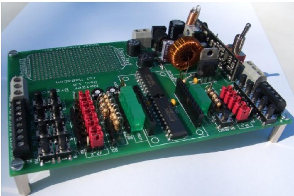
Die Platine kann mittels vier Befestigungslöchern auf Abstandsbolzen oder in einem Gehäuse montiert werden.
